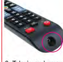
3- Televizyon kumandasındaki elektriği kızılötesi ışıığa dönüştüren kısım
