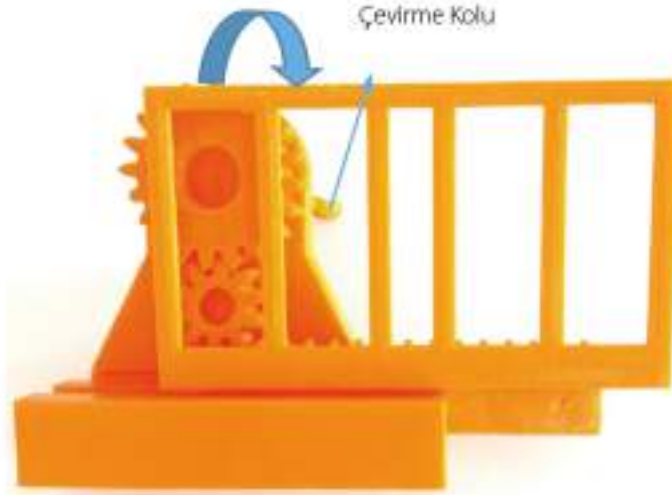
Görself 11: Tasarımı Yapılan El İle Kapı Açma Mekanizmasını Üç Boyutlu Yazıcıda (3B Yazıcı) İmalatı Yapılmış Parçalarının Montaj Yapılmış ve Kol İle Hareket Ettirilmiş İlk Sağdaki Durumu
