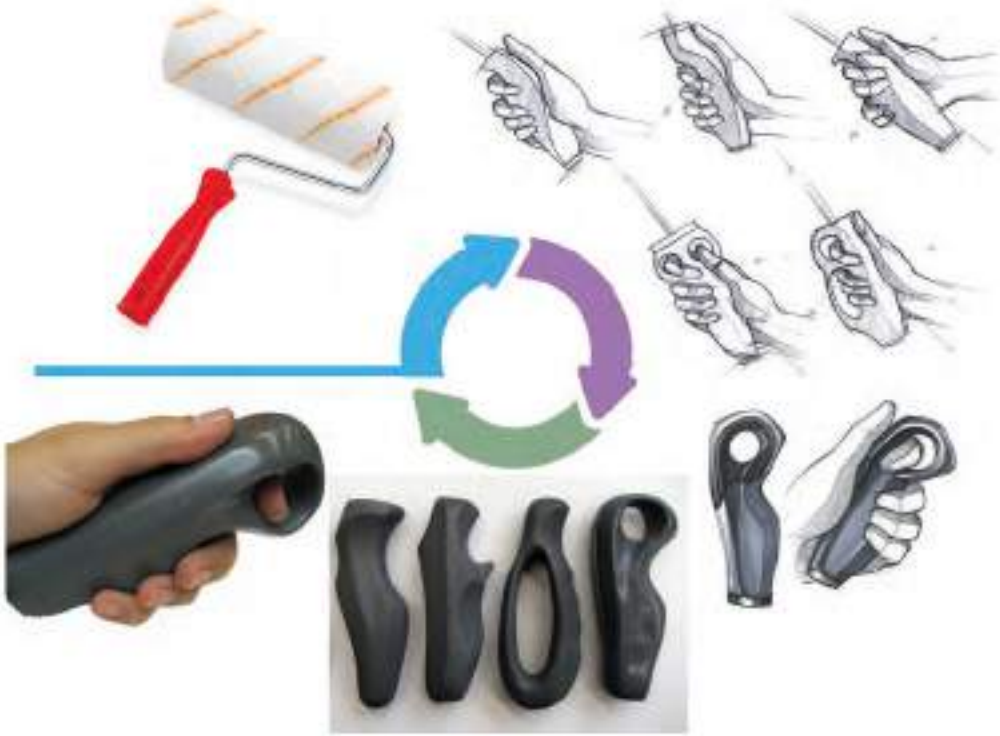
Görsel 17: Boya Rulosu Sapının Geliştirilmesi Süreci
