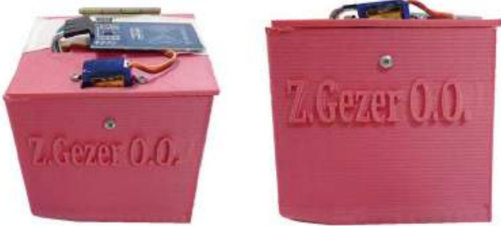
Görsel 13: Tinkercad Programında Tasarlanmış ve 3B Yazıcıda İmal Edilip Elektronik Bir Devre Kutusu Olarak Kullanılmış Son Hali
