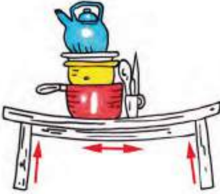
Görsel 16: Bir Masanın Ayaklarına ve Tablasına Gelen Yükler
