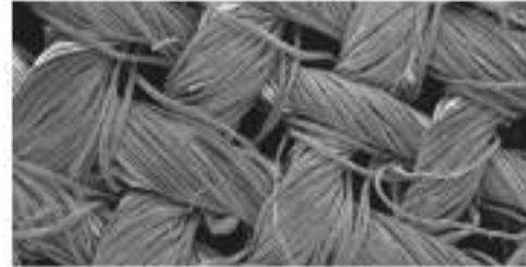
Görsel 8: Bakır ve gümüş nanoparçacıklı kendi kendini temizleyen kumaş dokusu
