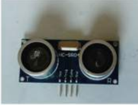
Görsel 1: Ultrasonik Mesafe Sensörü
