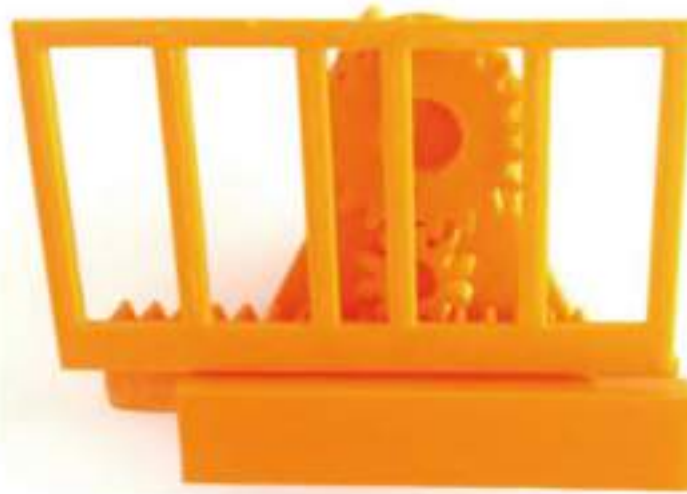
Görself 12: Tasarımı Yapılan El İle Kapı Açma Mekanizmasını Üç Boyutlu Yazıcıda (3B Yazıcı) İmalatı Yapılmış Parçalarının Montaj Yapılmış ve Kol İle Hareket Ettirilmiş İkinci Sola Doğru Hareket Etmış Pozisyonu
