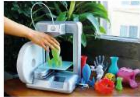
Görsel 26: Üç Boyutlu Yazıcı (FDM)
