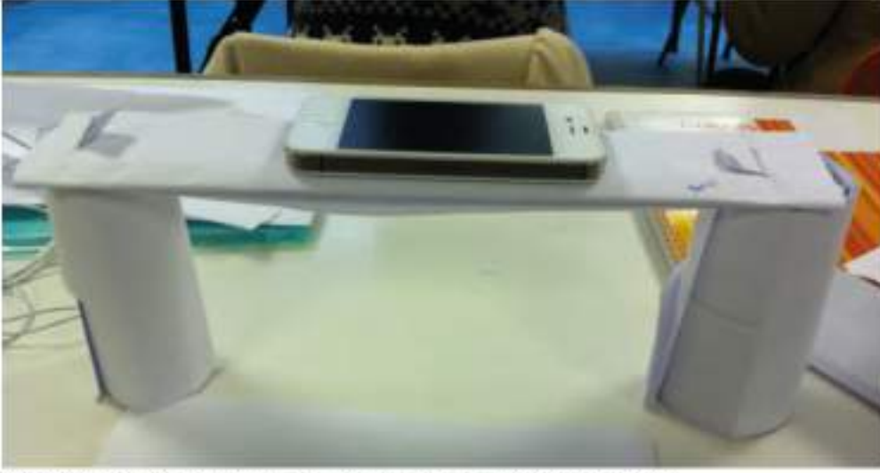
Görsel 12: Köprü ayakları da uygulama sürecine dahil edilebilir, köprüye farklı yükler taşınabilir.
