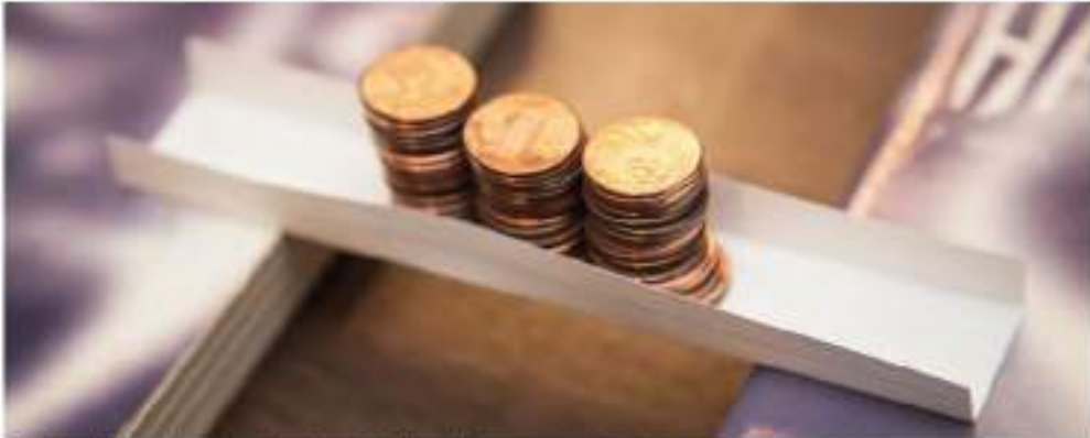
Görsel 11: Kağıt katlandığında ve biçimlendirildiğinde direnci artmaktadır.
