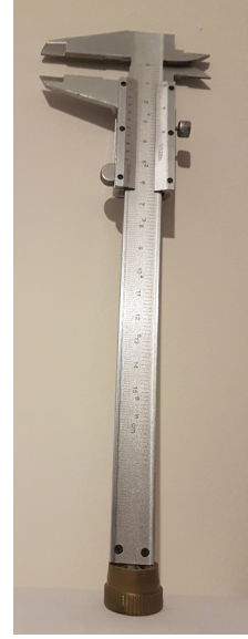
c) Kumpas ile derinlik ölçümü
