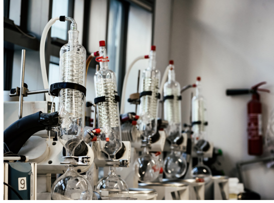
Görsel 3.160: Reaksiyon balonuna bağlanmış geri soğutucu
