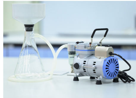
Görsel 3.166: Vakumlu süzme düzeneği
