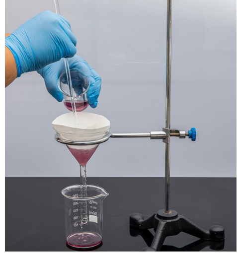
Görsel 3.165: Basit süzme düzeneği
