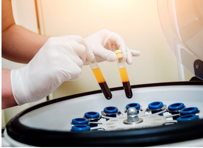
Görsel 3.167: Heterojen karışım örneğinin santrifüj ile çöktürülmesi
