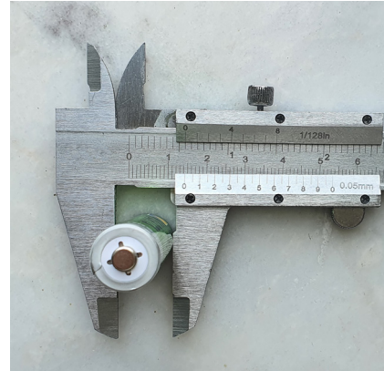
b) Kumpas ile çap ölçümü
