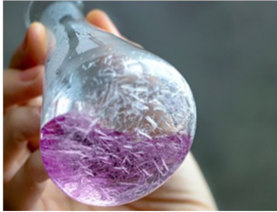
Görsel 3.171: Kristallendirme işlemi sonucu oluşan kristaller
