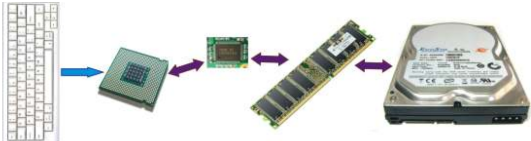
Klavye, İşlemci, Önbellek, RAM ve Sabit Disk Arasında Veri Akışı
